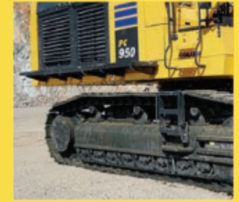
Trabzanlar, yürüme yolu ve güvenli yandan erişim merdiveni
